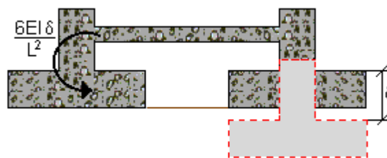
Figura 9 Momento Inducido en un Extremo de la Viga de Fundación por el Asentamiento Diferencial
